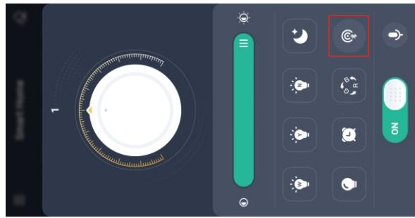
**7** Klikom na dugme sa satom otvarate prozor na kome možete podešiti automatsko isključivanje vaše lampe.
